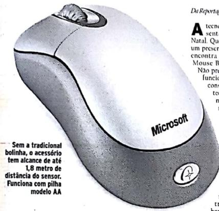
Sem a tradicional bolinha, o acessório tem alcance de até 1,8 metro de distância do sensor. Funciona com pilha modelo AA
